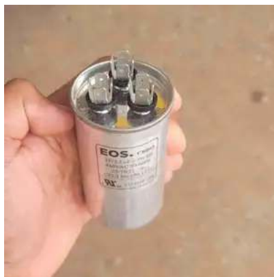
Troca de capacitor
