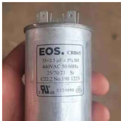
Troca de capacitor
