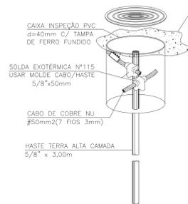
DETALHE DE INSTALAÇÃO DA CAIXA DE INSPEÇÃO TIPO SOLO COM CONECTOR DE MEDIÇÃO
