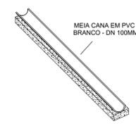
**DET. CANALETA DE SAÍDA - FILTRO ANAERÓBICO**
