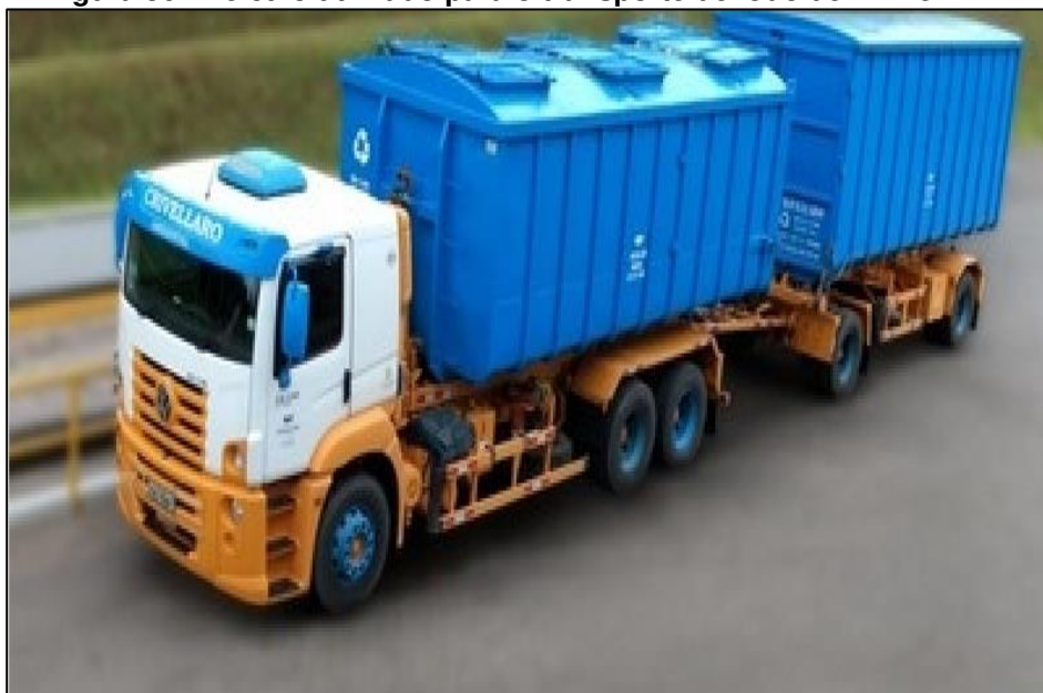
Figura 36 - Veículo utilizado para o transporte de lodo de ETE e ETA.
