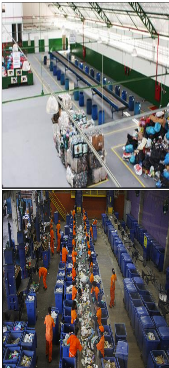
Figura 24 - Centro de Triagem de Resíduos Sólidos - CTRS e segregação de resíduos recicláveis e não recicláveis.
