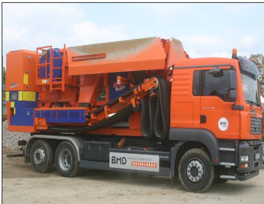
Figura 33 - Usina móvel de RCC.
