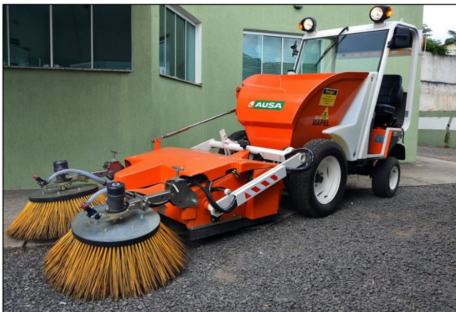
Figura 29 - Equipamento utilizado para varrição mecânica.
