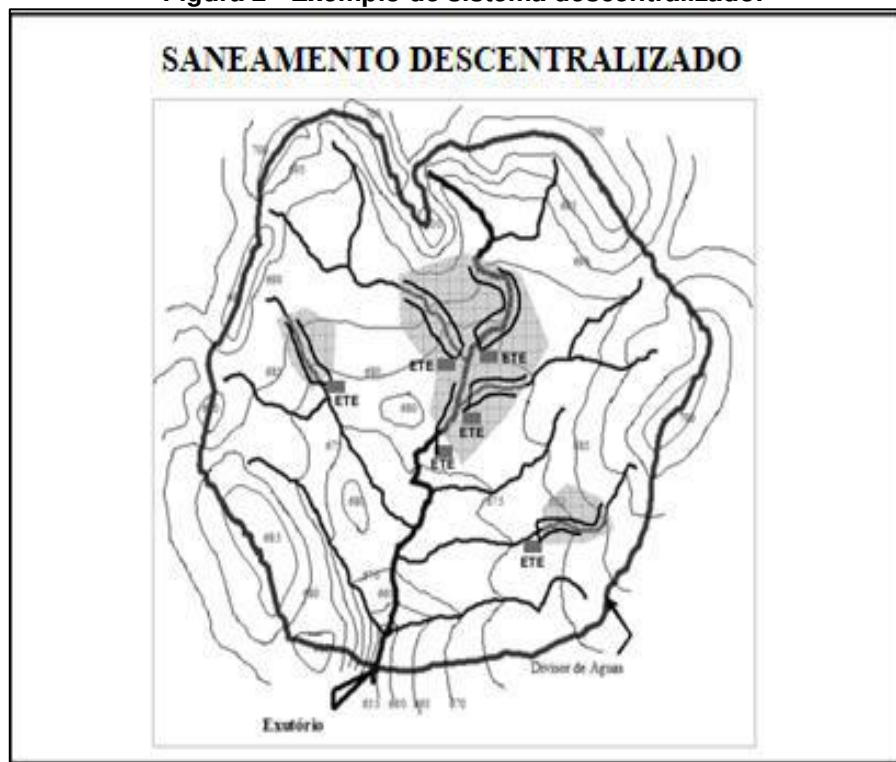
Figura 2 - Exemplo de sistema descentralizado.
