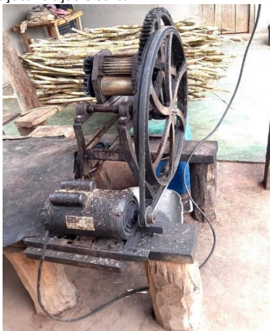
Figura 25 – Engenho para moer cana-de-açúcar tração elétrica
