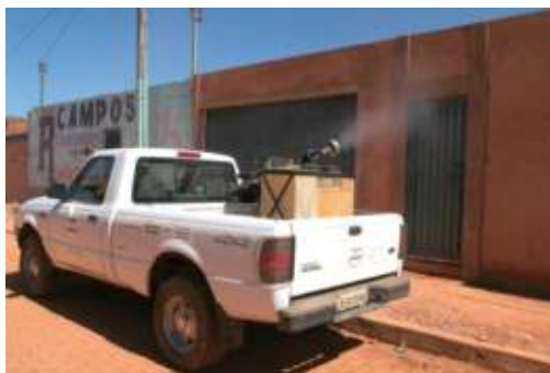
Figura 18. Uso de equipamento nebulizador acoplado a veículos
