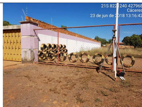
Detalhe do Receptor GNSS TOPCON HIPER II L2, rastreando o marco na Rua do Membeca.
