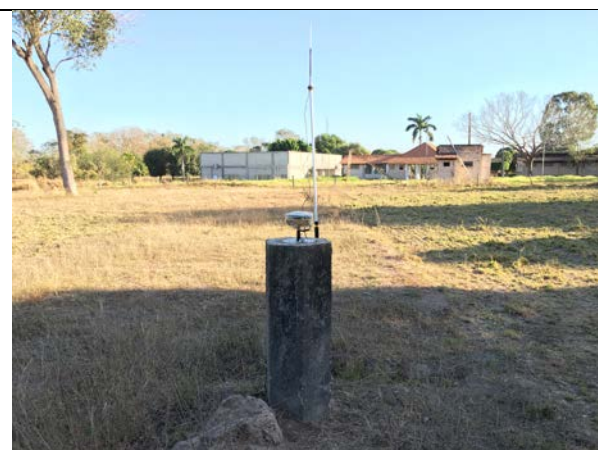
Detalhe do Receptor GNSS TOPCON HIPER II L1 e antena instalado na base SAT 91187 do IBGE, implantada dentro do Campus do IFMT
